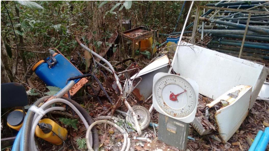
**Figura 27:** Tubulações, mangueiras e mangotes para irrigação avariadas ou com vida útil ultrapassada, armazenadas sob a influência de intempéries.
