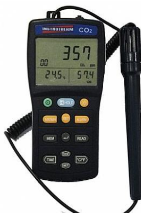
Figura 8 - Medidor de CO 2 , T e UR utilizado.
